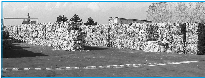
■ Vylisované balíky z přetříděného separovaného odpadu z třídící linky připravené k odvozu
