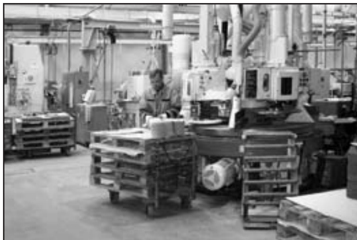
Planýrovací stroj BAR 80 pro obrábění čel brousicích kotoučů
