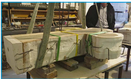
■ Výdusek kříže ve Kbele bude po vytvrdnutí usazen na připravený podstavec
